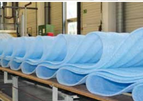
So läuft die Schaumfolie aus der Anlage
